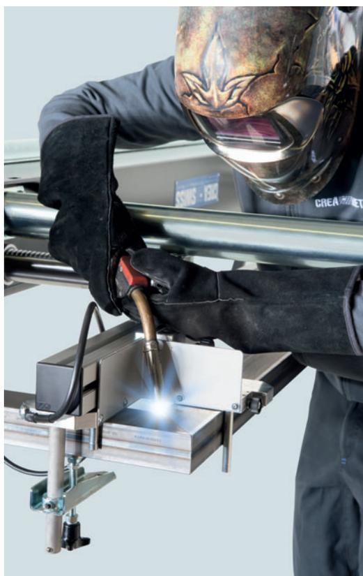
«Dispositif nécessitant qu'un seul opérateur» : régler les dimensions extérieures, placer les profils, ajuster la différence de hauteur et souder définitivement des deux côtés. Que ce soit des fenêtres en acier, des portes coupe-feu ou des cadres en profil acier : avec la CREA-SWISS, tous les collaborateurs fabriquent des cadres parfaits, de façon rapide, précise et rentable.
