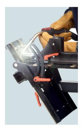
Pfostenschweisslehre für schnelles und rationelles Anschweissen von Platten und Handlaufschalen. Ob Geländerpfosten, Stützen oder kleinere Träger im Metallbau: Einmal eingestellt, produzieren Sie mit der CREA-FIX Einzelstücke und Serienteile. Bauteile einlegen und schweissen – schnell, präzise und effizient.
