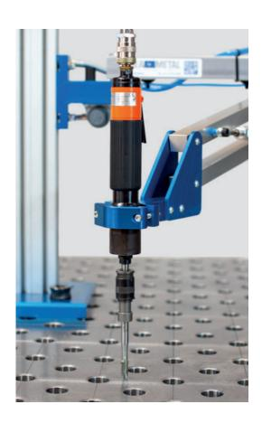
Mit der CREA-TAPP Gewindeschneidvorrichtung schneiden alle Mitarbeiter präzise und senkrechte Gewinde. Alle Gewinde gelingen im Handumdrehen.
