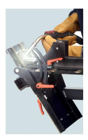
Gabarit de soudage permettant d'assembler rapidement et efficacement des plaques et des coquilles de main courante sur des montants. Qu'il s'agisse de poteaux de barrières, de montants ou de petits supports en construction métallique : une fois réglé, vous produisez aisement des pièces uniques ou en série avec le CREA-FIX. Positionner les éléments et souder : de manière rapide, précise et efficace.
