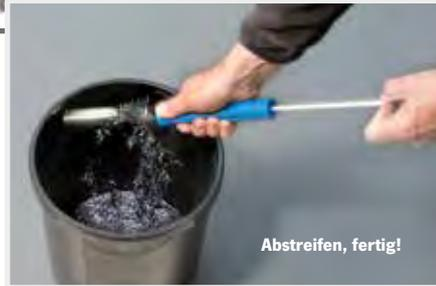
Der BDS PowerWORKER räumt auf mit allen magnetischen Bohrspänen. Mit diesem praktischen Werkzeug und seiner starken Magnetkraft werden Späne einfach eingesammelt und dann schnell und unkompliziert in den Schrottbehälter geschafft. Magnetisieren, einsammeln, abstreifen – fertig.
