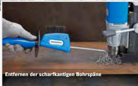
Entfernen der scharfkantigen Bohrspäne
