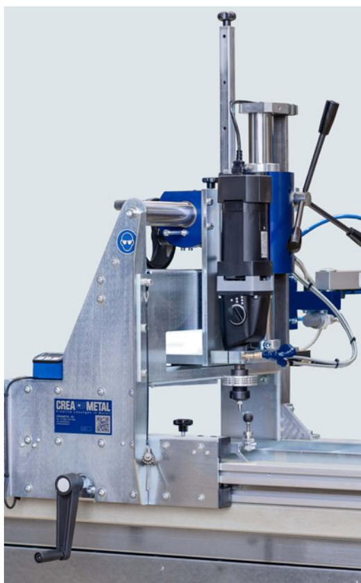
Fixez la pièce à usiner et percez immédiatement. Le centre de perçage CREA-DRILL élimine les opérations chronophages de mesure, traçage et pointage. Les entre-axes souhaités sont directement réglés à l'aide de commandes manuelles. Les axes X et Y sont dotés de graduations et, en option, d'affichages numériques. En plus du perçage conventionnel, le carottage et le fluoperçage sont également possibles.
