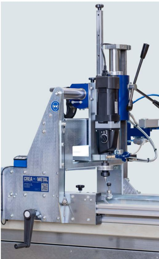
Werkstück einspannen und sofort bohren. Das Bohrcenter CREA-DRILL macht zeitaufwändiges Messen, Anreissen und Körnen überflüssig. Die gewünschten Masse werden per Handantrieb direkt eingestellt. Die X- und Y-Achsen verfügen über Massskalen, optional Digitalanzeigen. Nebst herkömmlichem Bohren ist Fließlochformen sowie Kernbohren ein Leichtes.
